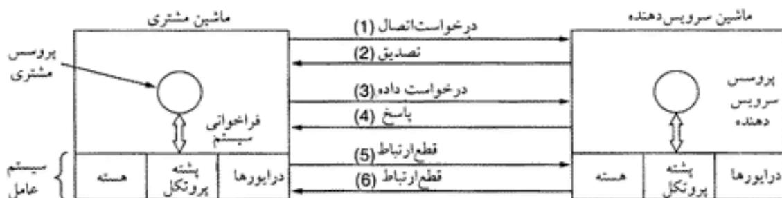
شکل ۱۸-۱. تبادل بسته ها در یک شبکه اتصال - گرای مشتری - سرویس دهنده.
